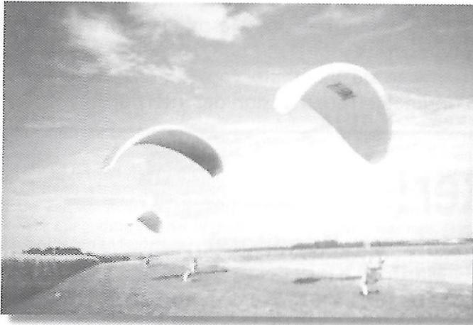
deren Kammern im Flug durch Staudruckluft gefüllt und versteift werden. Verbunden ist der Pilot mit dem Gleitsegel durch die von der Segelunterseite herablaufenden Fangleinen und das Gurtzeug. Das Gleitsegel wird normalerweise durch eine rechte
