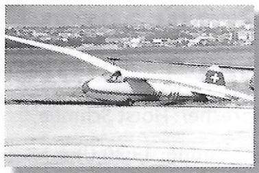
Zur Leistungssteigerung wurde beim S 18-2 die Spannweite auf 14,3 m erhöht. Im Jahre des Erstfluges 1937 gewann Spalinger die erste Schweizer Segelflugmeisterschaft. In den folgenden Jahren wurden weitere Erfolge durch die Piloten Max Schachemann und Schwarzenbach erzielt. Zwischenzeitlich wurde für einen französischen Piloten eine S 18-K mit 11,3 m Spannweite und verstärkten Holmen für den Rückenflug.
