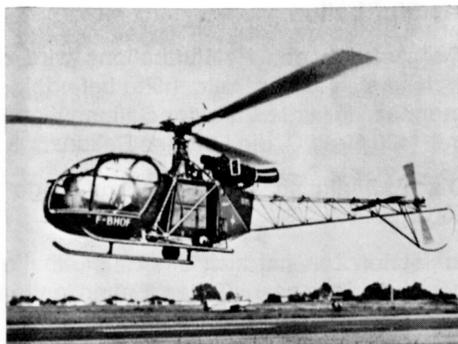
Rotor- $\phi$  10,2 m, Gewicht 895 kg, Rumpflänge 9,67 m, Zuladung 705 kg, PS/hp 360, Km/h 185, Dienstgipfelhöhe 4700 m, Reichweite 565 km.
