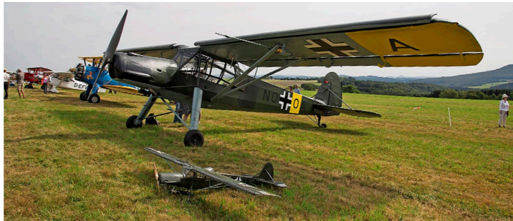
Diese Fieseler Fi-156 Storch ist eines der wenigen Exemplare mit den originalen deutschen Holzflügeln. Sie wurde erst kürzlich von dem Storch-Experten Dirk Bende restauriert.
